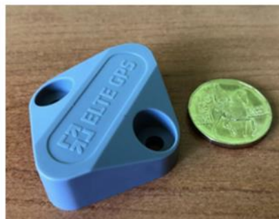
Obr. 3 - RFID čip - kovová popelnice
